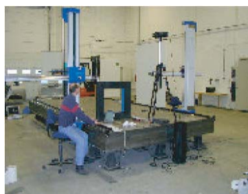
kontrola pomocí laseru a úhlového etalonu
