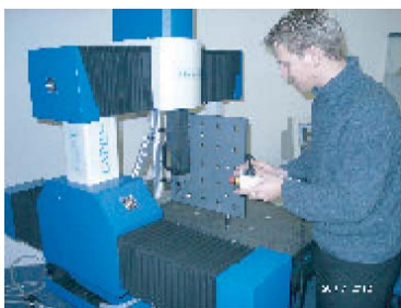
kontrola pomocí kalibrovací desky
